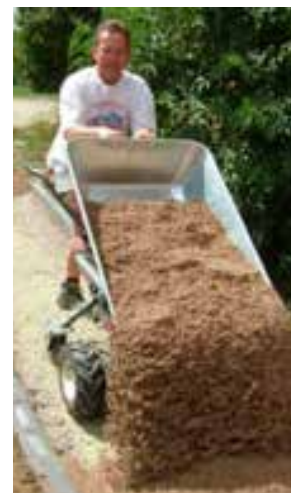
Lastekaret kan enkelt vippes og tillater fullstendig tømming.
