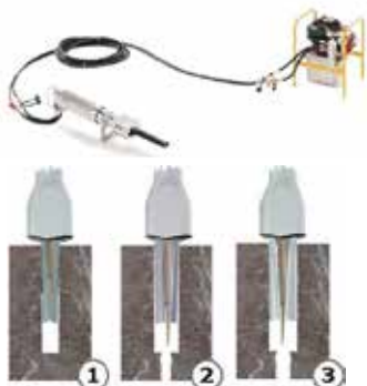
2. Senk "splitteren" i hullet enten horisontalt eller vertikalt.
